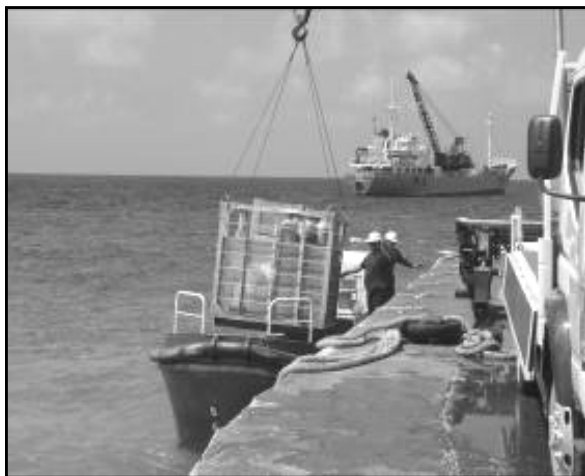
大型岸壁がないため小型船に積み替えて陸揚げ
