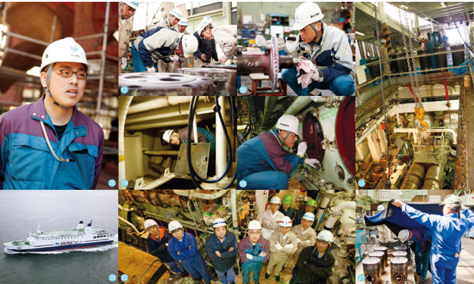
5. 船舶の最下部にあたる部分の検査 6. スクリュー部分。この回転が船舶の推進力となる 7.8. 高所作業車に乗り込んだり、船底の開放部に体を入れ込んだり 9. 漁船のラダーストックのための検査 10. 検査後の書類確認 11. 検査後に交付される「船舶検査手帳」「船舶検査証書」。これがないと航行できない。国内間の物資の輸送を行っている貨物船や漁船については5年毎の定期検査とその中間に行う中間検査があり、旅客船や国際航海船舶については5年毎の定期検査と毎年行われる中間検査がある 12.13. 現場では菊池が主に検査し浅利がフォロー 14. 海事事務所で執務中の浅利(右)と菊池。同じ大学の先輩後輩でもある 15. 普段はパーキングであるスペースに開いた穴から機関室が見える 16.17. 修繕工場での検査 18.19. 機関室内での検査 20. 浅利和春。「検査官になって最初に検査した船舶のことは一生忘れません」 21. 協力工場で。直射日光が当たらないようにシートで覆いながら検査 22. 整備中の船内で働く人は茶髪の若者からベテランまで年齢層が幅広い。所属も造船会社、フェリー会社、そして船舶検査官などさまざまだが、みな海の男としての誇りを持っている 23. すべての検査を終え、びかびかになって函館に帰る『びるご』。総トン数6,706トン、全長134.60メートル、幅21.00メートル、輸送車輛トラック65台または乗用車200台、輸送人員600名。船名はギリシア神話のゼウスとテミス間に生まれた女神の名前に由来する
