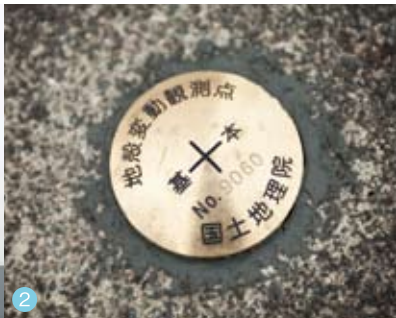
1. 東海機動観測基地。緊急時にはデータ観測の最前線となる 2. 地殻変動観測の基準点であることを示す銘版。基地屋上に設置されている 3. 基地屋上に設置されたGPS連続観測点。人工衛星からの電波を受信して各観測局間の地殻変動を連続的に捉える 4. 基地内で周辺地図を見ながら試験測量の打ち合わせ
