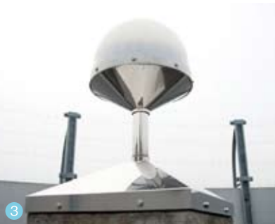
1. 東海機動観測基地。緊急時にはデータ観測の最前線となる 2. 地殻変動観測の基準点であることを示す銘版。基地屋上に設置されている 3. 基地屋上に設置されたGPS連続観測点。人工衛星からの電波を受信して各観測局間の地殻変動を連続的に捉える 4. 基地内で周辺地図を見ながら試験測量の打ち合わせ
