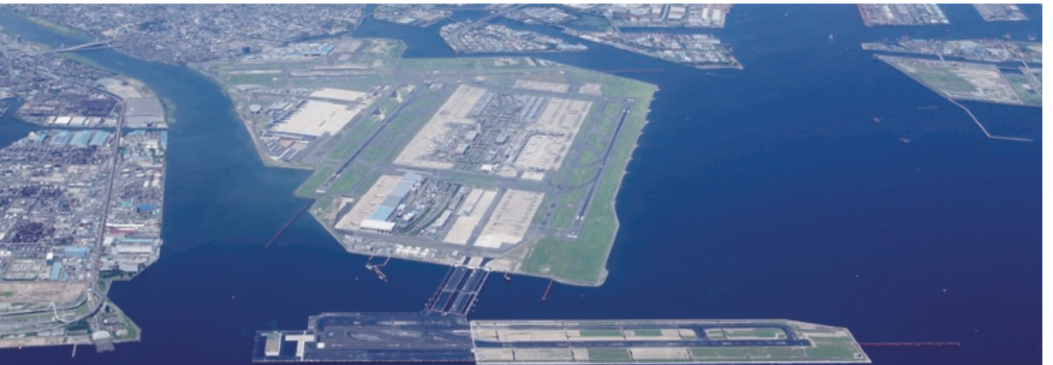
⑩世界的に珍しく、また高度な管制を要求される「井」の字の形をした4本の滑走路を持つ羽田空港
