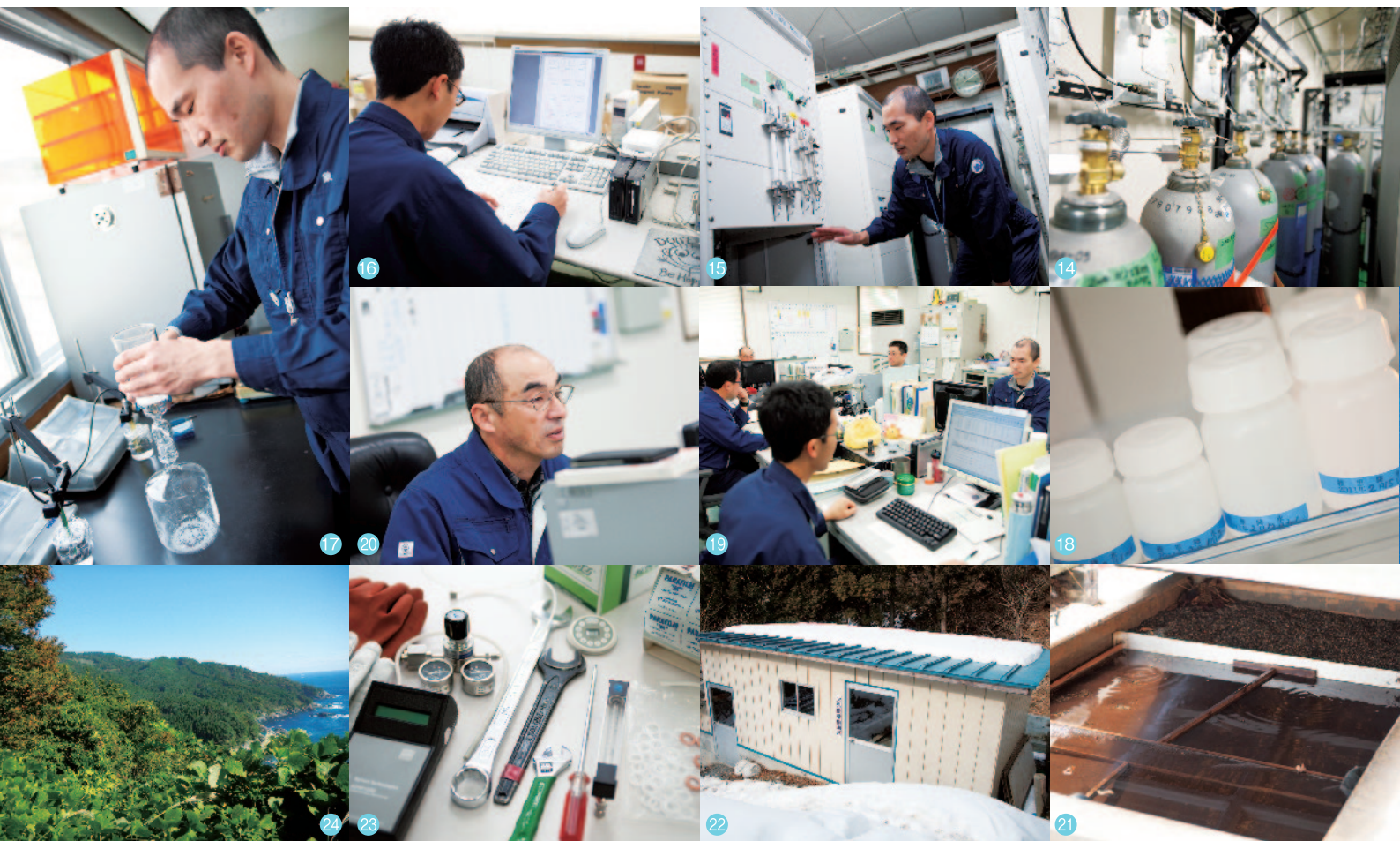
5. 観測用の大気を取り入れる鉄塔と、手前がエアロゾルライダーが設置されている施設 6. 観測所のメンバー。右から高辻慎也、滝沢、須藤幸男(所長)、大清水泰樹(主任技術専門官)、伊藤公博(技術主任) 7.8.9. 観測機器の点検を行う高辻。一つひとつ丁寧にチェックしていく 10. エアロゾルライダーから発射されたレーザー光が夜空に伸びる 11. エアロゾルライダーを設置する施設の室内。精密機械のため室温は厳重に管理されている 12.13. 鉄塔から取り込まれた大気を用い、温室効果ガスなどを測定している新観測室。天井には配管や配線が張り巡らされている 14. 観測室には濃度を測定する際の基準となるガスボンベが並ぶ 15. 主にオゾン層の破壊物質を観測する第三観測室にて、分析計の説明をする滝沢 16. 観測機器により得られた観測データをチェックする 17.18. 採取した降水は分析室で処理される 19. それぞれの席につき、デスクワークをこなす職員 20. 所長である須藤は、「毎日無事にスムーズな観測を行えるのが一番ですね」と話す 21.22. 観測所の水源となる取水口。生活用水としてだけでなく、さらに不純物を除去して観測にも用いられている 23. 観測には流量計や調圧器など、必須アイテムが盛りだくさん 24. 職員が通勤時に撮影したもの。三陸海岸が織り成すこの美しい光景は、ここで働くものだけへのご褒美だ
