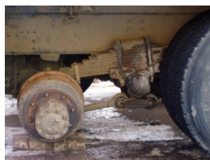
大型自動車の 車輪脱落事故
