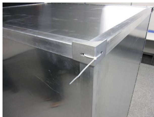
簡易なケーブルバインダーによる封印
