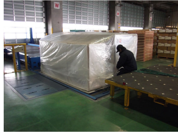
・ビニールかけ作業
