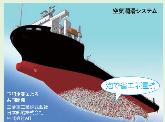
船底を泡で覆い摩擦を低減、燃費を向上させる。
