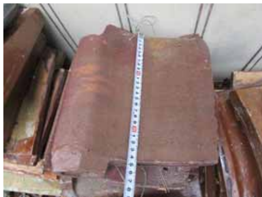
写真 1-13 江差にある石州瓦と越前瓦 ※本願寺江差別院 北海道江差町 (赤瓦研究委員会撮影) 左上:最近(平成5年)石州瓦で葺き替えられた屋根 右上:土塀の屋根の越前瓦 左下:土塀脇に積んである越前瓦 右下:土塀脇に積んである石州瓦(サイズと釉薬のかけ方が異なる)
