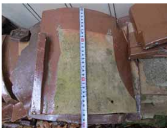
写真 1-13 江差にある石州瓦と越前瓦 ※本願寺江差別院 北海道江差町 (赤瓦研究委員会撮影) 左上:最近(平成5年)石州瓦で葺き替えられた屋根 右上:土塀の屋根の越前瓦 左下:土塀脇に積んである越前瓦 右下:土塀脇に積んである石州瓦(サイズと釉薬のかけ方が異なる)
