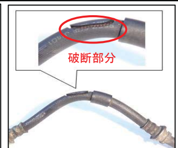
<ブレーキホースの破断事例>
