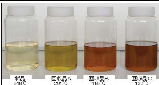
<使用過程車から回収したブレーキ液の沸点>
