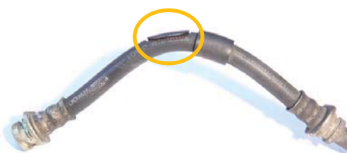
ブレーキホースが破断した例
