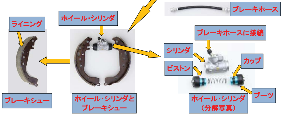
ドラムブレーキの構造
