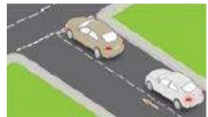
静止障害物試験
