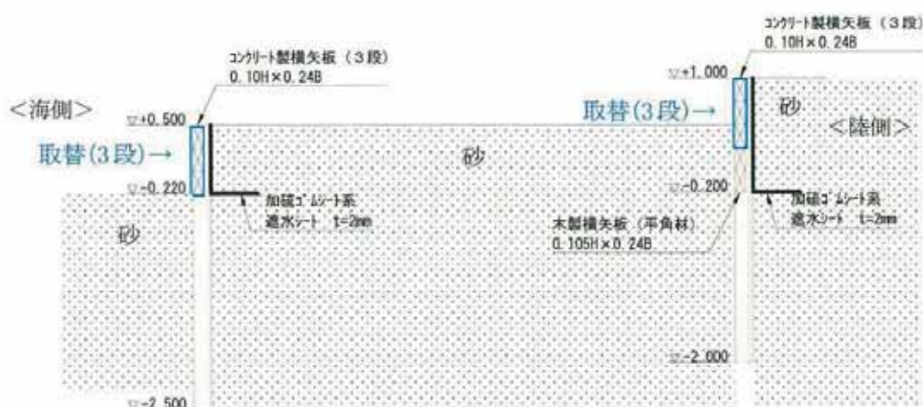
図 矢板の修繕工
