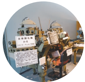
地図を描くのに以前実際に使われていた立体図化機。現在は「地図と測量の科学館」内に展示されている
