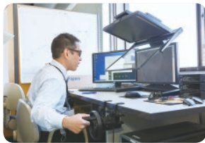
デジタル立体図化機。専用眼鏡をかけると写真が立体に見える、地形に沿いながら描き起こしていく。ただし操作方法は以前のものと変わらずハンドルで操作する
