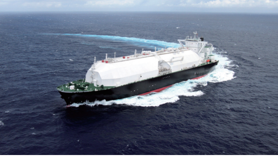
上/三菱重工の「さやえんどう」LNG船。球形のLNGタンクを船体と一体構造の連続カバーで覆い、丈夫で軽く、かつ空気抵抗の少ない形を実現した。 左/川崎重工が製造した球形のLNGタンク。天然ガスを-162度の低温で液体化して貯蔵し、海上輸送する。
