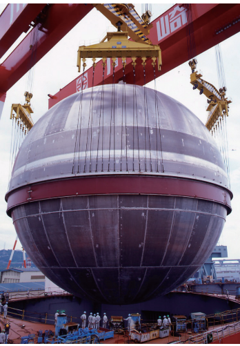
上/三菱重工の「さやえんどう」LNG船。球形のLNGタンクを船体と一体構造の連続カバーで覆い、丈夫で軽く、かつ空気抵抗の少ない形を実現した。 左/川崎重工が製造した球形のLNGタンク。天然ガスを-162度の低温で液体化して貯蔵し、海上輸送する。
