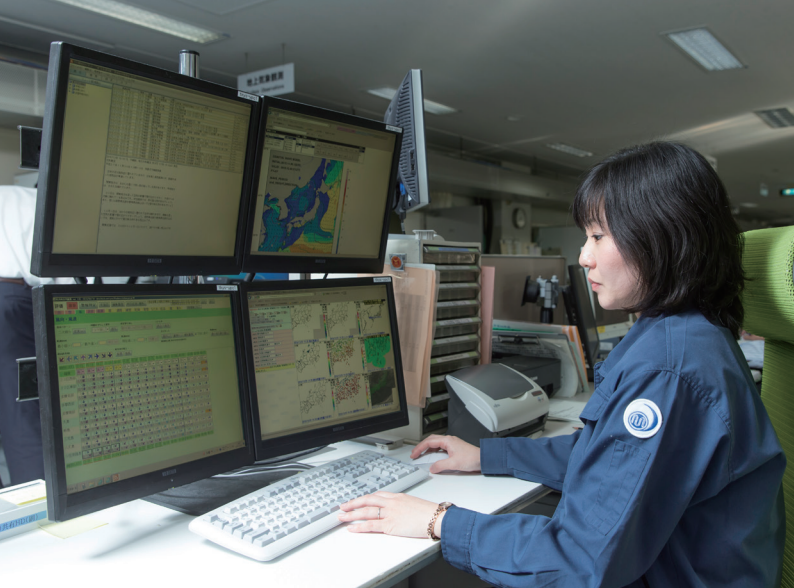
予報官のデスクには複数のモニターがあり、スーパーコンピュータの気象予測に加えて、衛星画像による雲の動きなどさまざまな情報を確認できる。予報官たちは、これらのデータを基に、システムに情報を入力して気象予報を作成する。雨量や風速の予報も同様に作成する。
