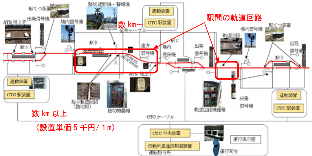
図1 地方中小鉄道線の一般的な構成
