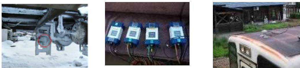
図3 試験装置（左：レーザドップラ車速計 中：衛星測位受信機 右：衛星測位アンテナ）
