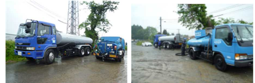
②バキューム車から大型車へ積み替え
