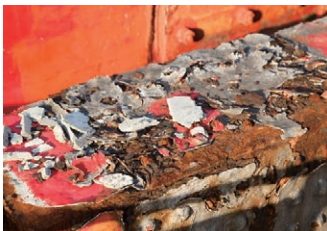
塗装の剥がれ具合を実際に見ることができます。
