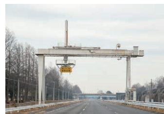
道路標識の見やすさなどを試験する設備
