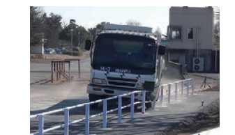
ガードレールの衝突安全性検証実験
