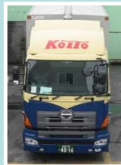
軽量導風板の導入により34kgの軽量化。
