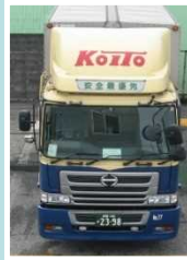
軽量導風板の導入により34kgの軽量化。
