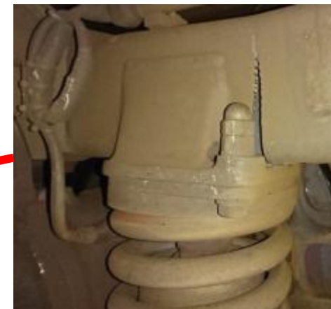
台車枠の一部に亀裂
