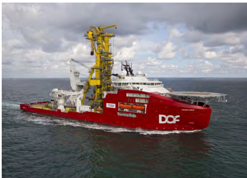
図 5.6.5-10 650mt の Flex-Lay システムを SKANDI AFRICA に搭載した例
