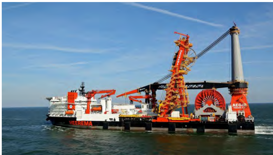
図 5.6.5-11 2000Mt の Multi-Lay システムを Heerema に搭載した例（J-/Reel-/Flex-Lay システムを搭載している）
