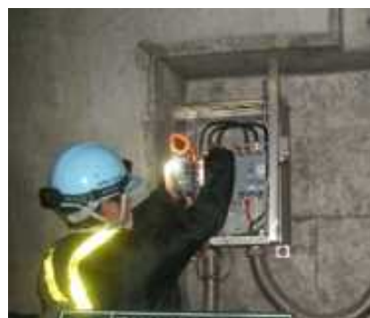
写真 5.3 絶縁抵抗測定
