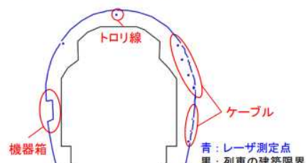
トンネル建築限界の測定(イメージ)
