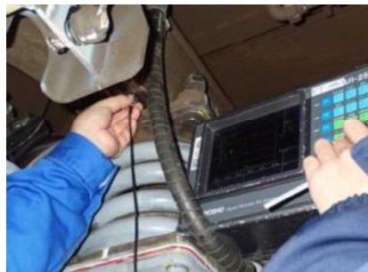
【超音波探傷状況】
