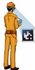
現場に配置したマーカーの画像認識により基準点を設定
