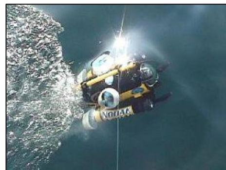
ダムの堤体や機械設備等の水中部の調査に活用
