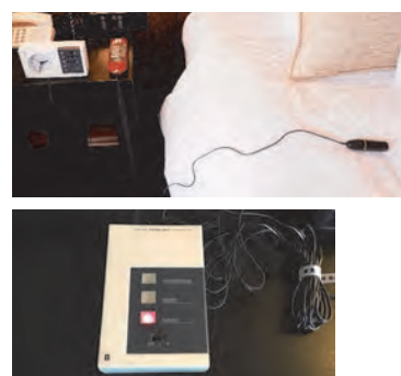
・戸に設けられた、来客（ノック）等の音を拾って光と振動でお知らせするノックセンサー（左）と、目覚まし・来客（ノックセンサー）・ファックス等を光で伝える時計型の受信機器（中央）、振動で伝える受信機器（右上）、送信機器（左下）（全室を対象に貸し出し可能となっている。）
