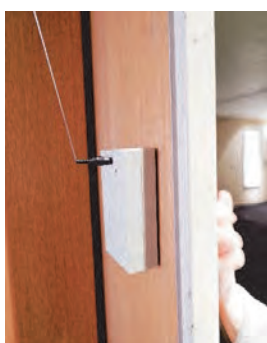
・戸に設けられた、来客（ノック）等の音を拾って光と振動でお知らせするノックセンサー（左）と、目覚まし・来客（ノックセンサー）・ファックス等を光で伝える時計型の受信機器（中央）、振動で伝える受信機器（右上）、送信機器（左下）（全室を対象に貸し出し可能となっている。）
