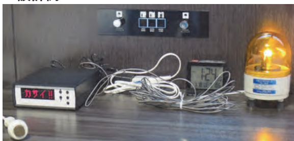
・緊急通報ボタン（左）又は、従業員からの電話連絡に反応し、文字情報や光で火災等の発生を伝える装置
