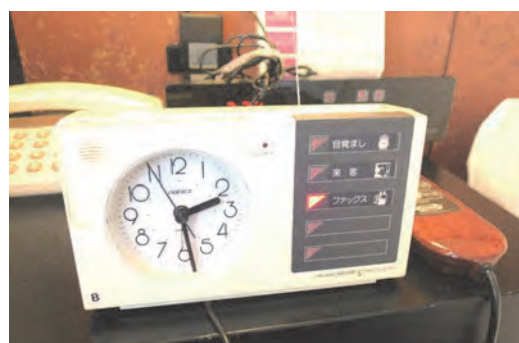
・戸に設けられた、来客（ノック）等の音を拾って光と振動でお知らせするノックセンサー（左）と、目覚まし・来客（ノックセンサー）・ファックス等を光で伝える時計型の受信機器（中央）、振動で伝える受信機器（右上）、送信機器（左下）（全室を対象に貸し出し可能となっている。）
