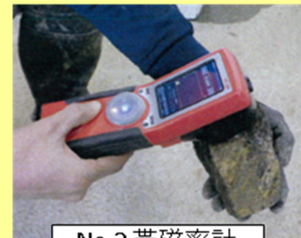
No.2 帯磁率計 (ロック材の岩種判別)
