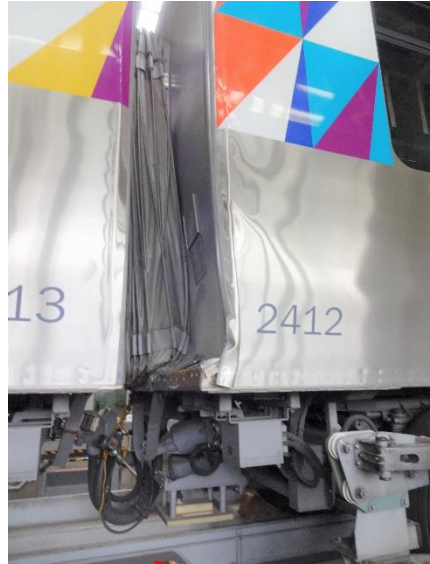
↓2号車妻構体変形 (台枠との接合が外れ)
