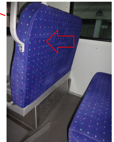
↑5号車2位クロスシート変形 (衝突側に傾き)
