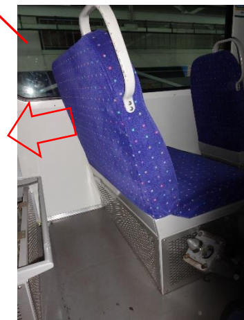
↑4号車4位クロスシート変形 (衝突側に傾き)
