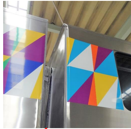
↓2-3間3号車妻構体変形 (妻、屋根構体接合付近変形)
