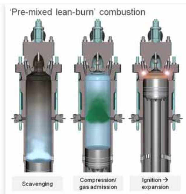
図 4.1.39 X-DF の掃気、圧縮・燃料噴射、燃焼過程 39)
