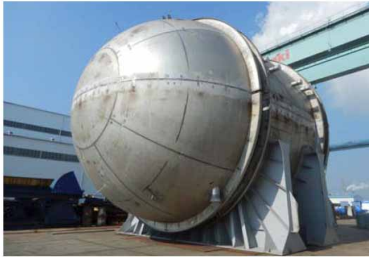
図 4.1.67 1,000 m 3 液体水素貯蔵試験設備 70)
