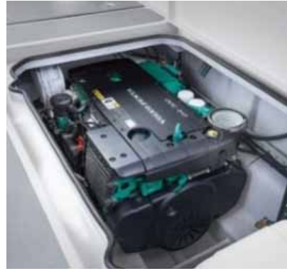
図 4.1.62 水素エンジン船「HYDROVILLE」および搭載されている VOLVO 社製エンジン 65)
