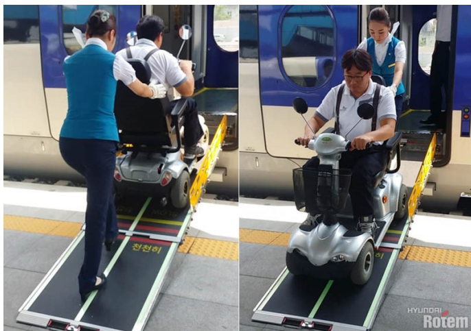
乗降時のみ傾斜路を展開して、駅員の介助により、車椅子が乗降する
