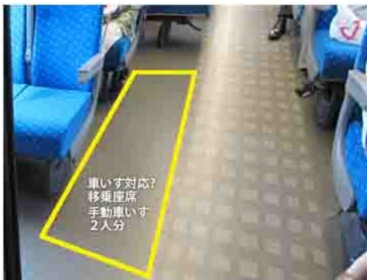
東海道新幹線 N700 系の移乗座席／電動車いすは通路にはみ出して乗車
