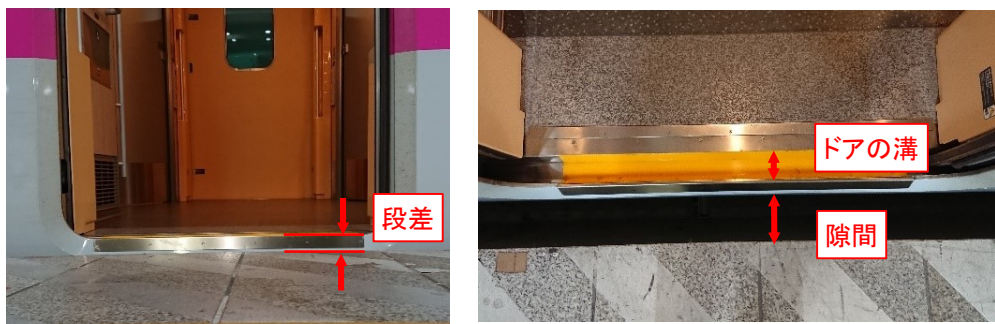
車椅子対応号車である5号車・9号車の乗降口幅は1,010mm。その他は660mm
