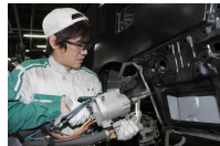
超高張力鋼板の溶接
