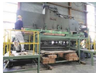
③ 道内業者によるCLT製作
