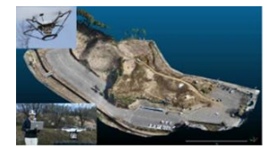
ドローンを用いた写真測量による面的な3次元測量を実施
