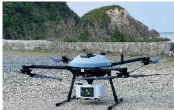
グリーンレーザー搭載ハイブリッドドローン メーカー側で、ガソリン燃料発電機よりバッテリーに 給電可能としたハイブリッド型ドローンを開発 長時間飛行による測量、空撮が可能となった。
