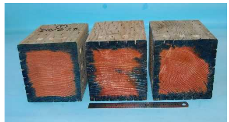
写真-4 薬剤の浸潤状況確認の例
