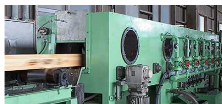
写真-9 深浸潤処理 (薬液吹付装置) の例
