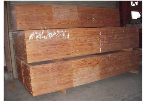
写真-5 ラッピングした大断面集成材の例 (ラッピングのない中心部分が接合部)
