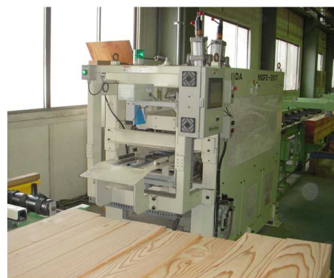
写真-5 グレーディングマシンに組み込まれたラミナ材の含水率計測の例 (ライン状に全て計測可能で、ヤング率も同時に50mmピッチで計測することが可能)
