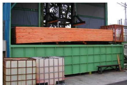
写真-6 浸漬槽 (全面浸漬用)の例
