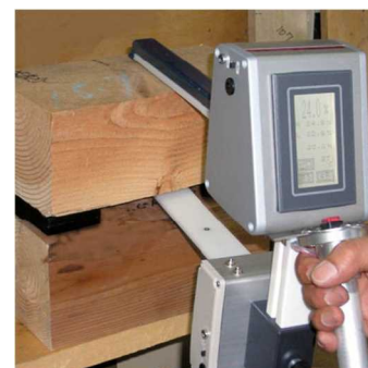
写真-8 マイクロ波式水分計の例
