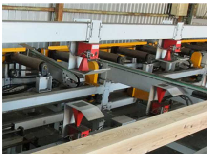
写真-1 JAS 認証工場で自動化されたマイクロ波による含水率の測定の例
