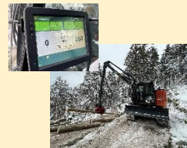
↑木材データから最適なプランを提示し採材するICTハーベスタ
