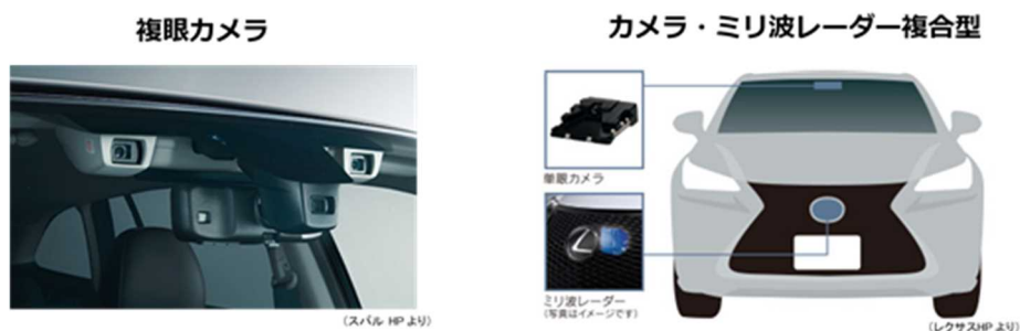
図：電子制御装置整備の対象となる装置の例
