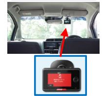
事故自動通報システム
