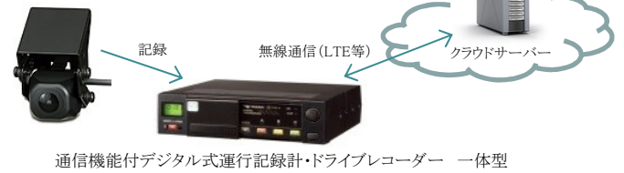
通信機能付デジタル式運行記録計・ドライブレコーダー 一体型
