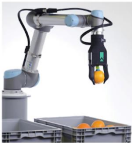
ピッキングロボット
