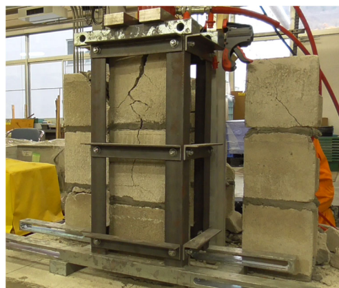
補強鉄筋の引抜実験
