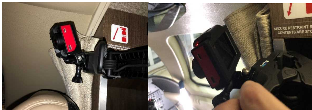
図 2-7 テキストロン・アビエーション式 525C 型(サイテーション(CJ4 型))への取り付け事例
