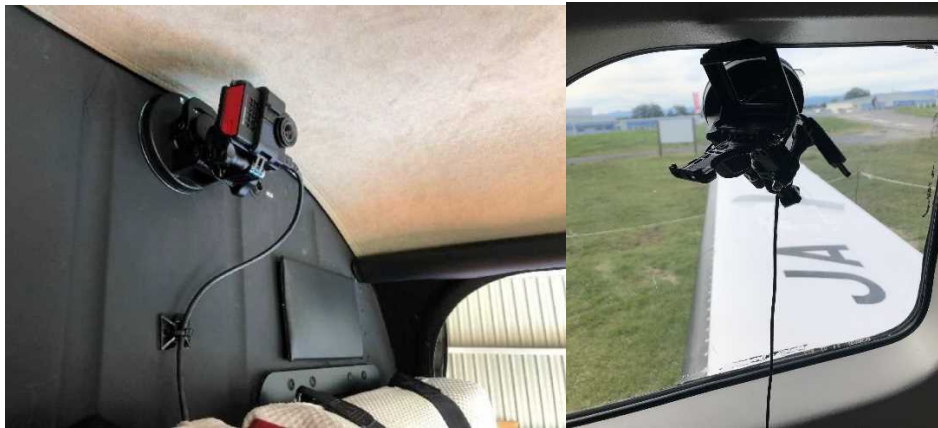
図 2-8 ベル式 505 型(B505) (左)、ソカタ式 TBM700 型(右)への取り付け事例
