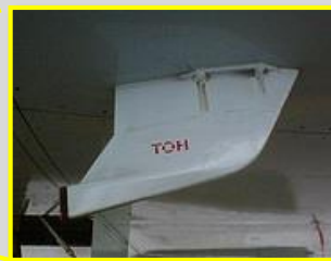
加熱機構付き 機外排出管
