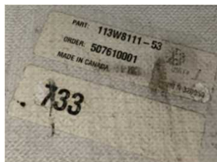
主脚構造部のシール (大きさ 10cm×3cm、重量 1g)
