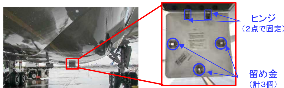
給水口扉の位置
