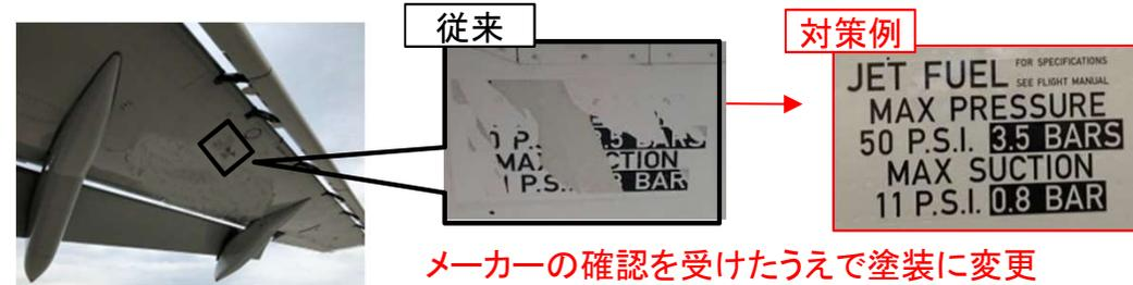
燃料給油圧力制限のデカルの塗装化
