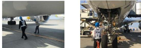
機体の胴体・主翼(エンジン含む)・脚などに部品欠落・着氷等がないか点検
