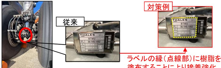
主脚構造部のラベルの接着強化
