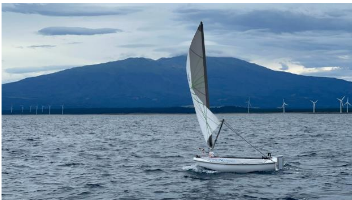
帆船ドローンによる無人航行実証実験の様子 〔エバーブルーテクノロジーズ船体 AST-231〕
