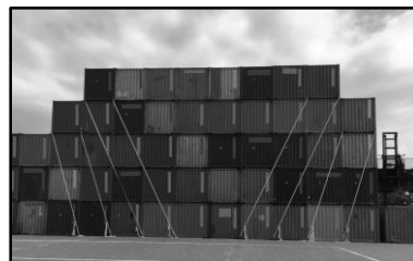
ベルトによる空コンテナの固縛の状況(8本使用)
