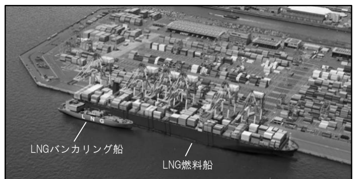
LNGバンカリング (Ship to Ship) (イメージ)
