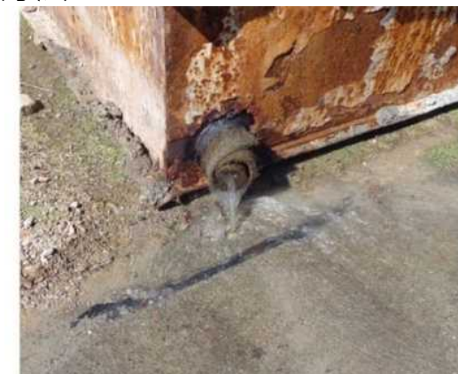
排水フィルター (巻いて排水口に挿入)
