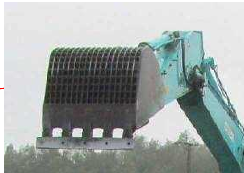
スケルトンバケット(2mmメッシュ装着)
