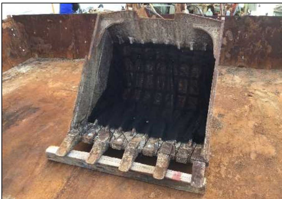
参考写真②: スケルトンバケット(2mmメッシュ装着)
