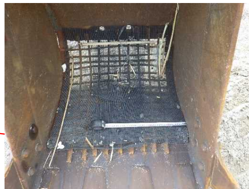
スケルトンバケット(5mmメッシュ装着)
