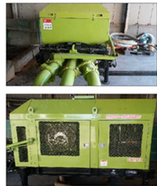
ベース機種はシンテック定置式SP-60E 吸引と圧送を同時に行う事が特徴となります。
