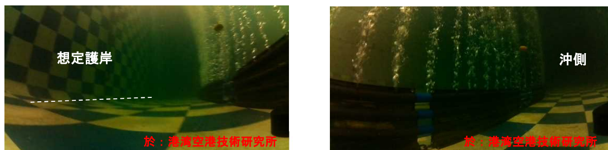
図-2. エア吹き出し状況（左：想定護岸側 右：沖側想定）
