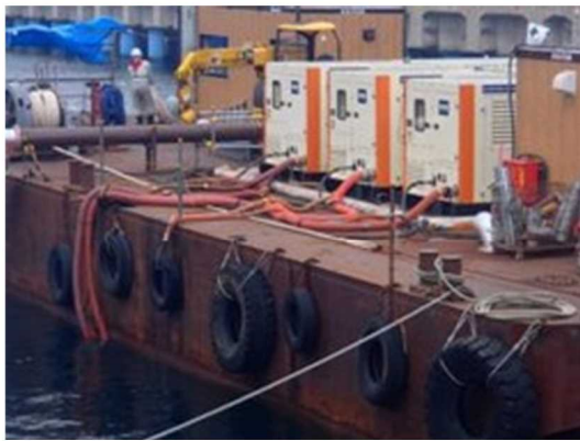
WJCUTTER(ウォーターカッター) 14.7MPa 900L/min 重量1台10 t
