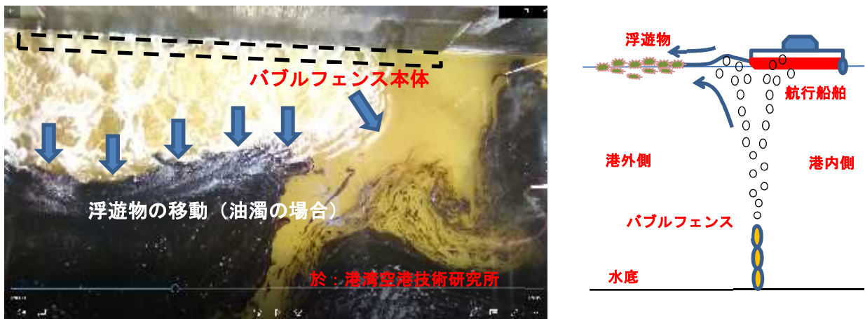
図-3. バブルフェンス工法による浮遊物（油濁）の制御
