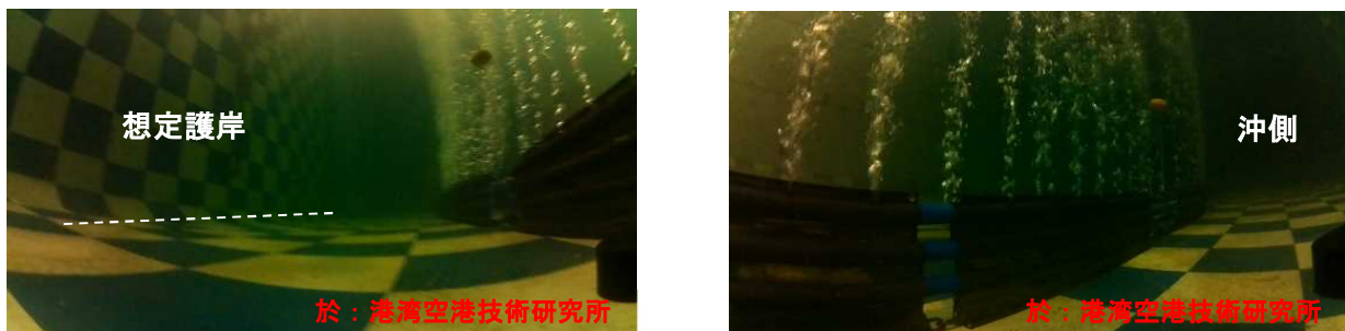
図-2. エア吹き出し状況（左：護岸側想定 右：沖側想定）
