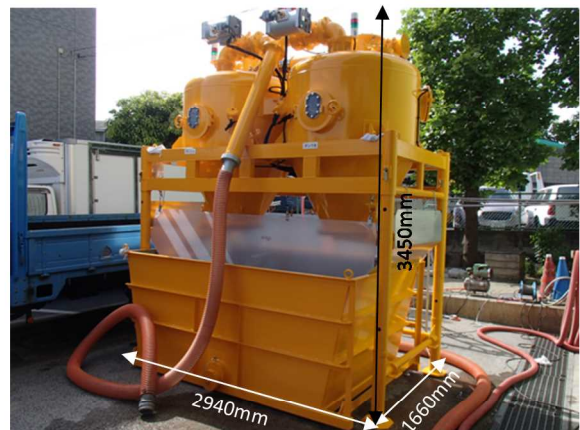
連続吸引排水装置外観写真
