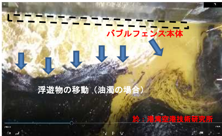
図-3. バブルフェンス工法による浮遊物（油濁）の制御
