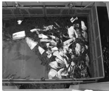
吸着マットによる油回収
