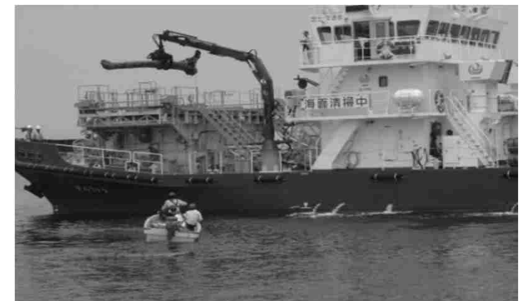
多関節クレーンによる流木の回収
